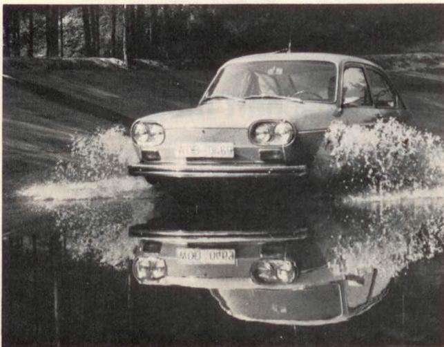
Schotterstrecken, gewölbte und glatte Fahrbahnen mit Frostaufbrüchen; Höckerkurven, Wasserdurchfahrten, Aquaplaningstrecken sowie Kreisschleuderstrecken mit Berieselungsanlagen. Auch ein künstlicher Berg ist Teil der Versuchsanlage. Er hat alpine Straßenverhältnisse – Steigungen bis zu 32 Prozent und Serpentinaugen wie auf einer Paßstraße.
