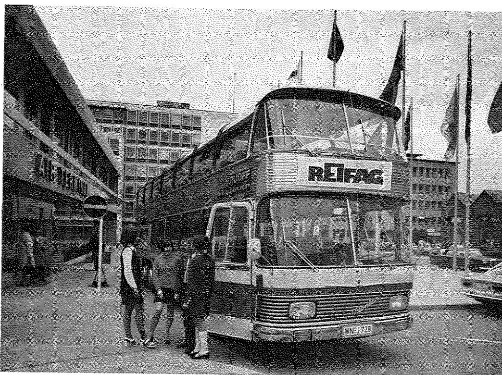
Zur Beförderung ausländischer Journalisten und als rollendes Presse-Büro stellt REIFAG diesen Omnibus zur Verfügung. Das Fahrzeug vom Typ Skyliner hat 75 Schlafesseln, Klima-Anlage, Toilette, Waschgelegenheit, eine Bar und Arbeitstische; es wurde kürzlich in Nizza bei einem Wettbewerb prämiert.
